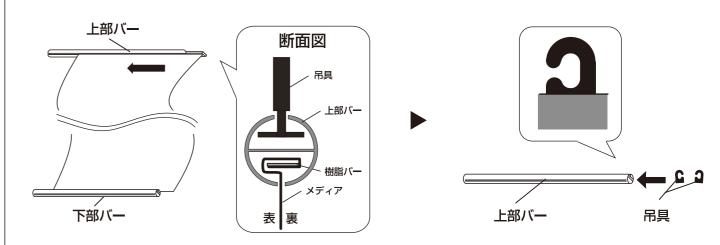
① 樹脂バーを貼り付けたバナーを上図のように折り曲げ、上部バーと下部バーの溝にゆっくりと差し込みます 次に上図のように上部バーに吊具を取り付けます
