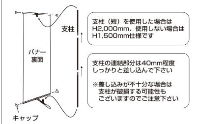
④ キャップを上部・下部バーの両端に取付けて必要数を 連結した支柱を上部接続パーツとウエイト部に接続します
